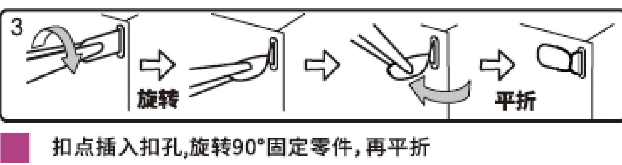
扣点插入扣孔,旋转90°固定零件,再平折
