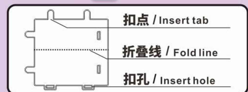
识别金属零件上的扣点, 折叠线, 扣孔的样子
