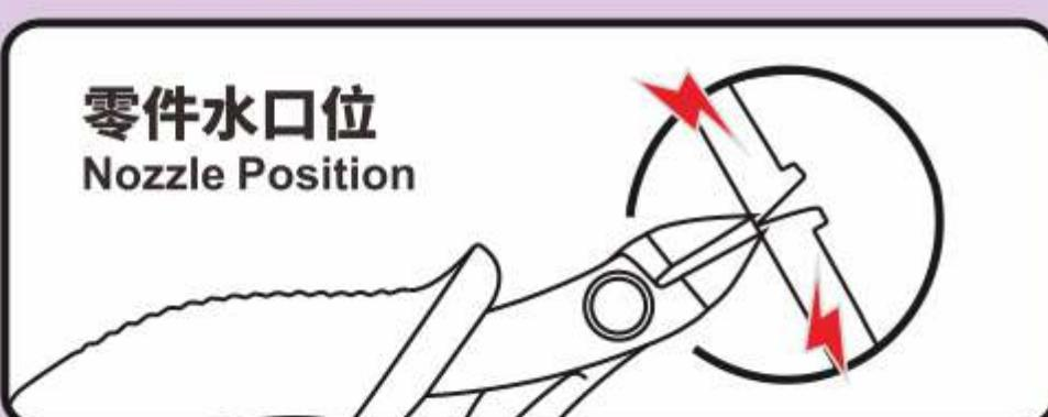
使用水口钳剪断金属零件上的水口, 将需要的金属零件从金属片板件取下
