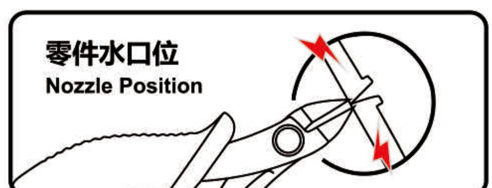
使用水口钳剪断金属零件上的水口，将需要的金属零件从金属片板件取下。
