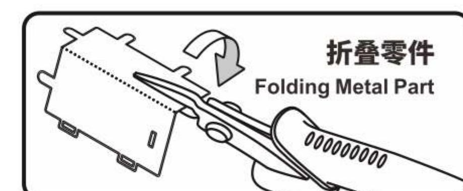
使用尖嘴钳,参照拼装说明书将金属零件折成形状
